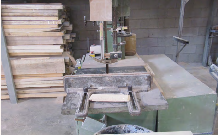
Sierra de cinta con protector automático de la zona de operación y guía de apoyo. INVASSAT
