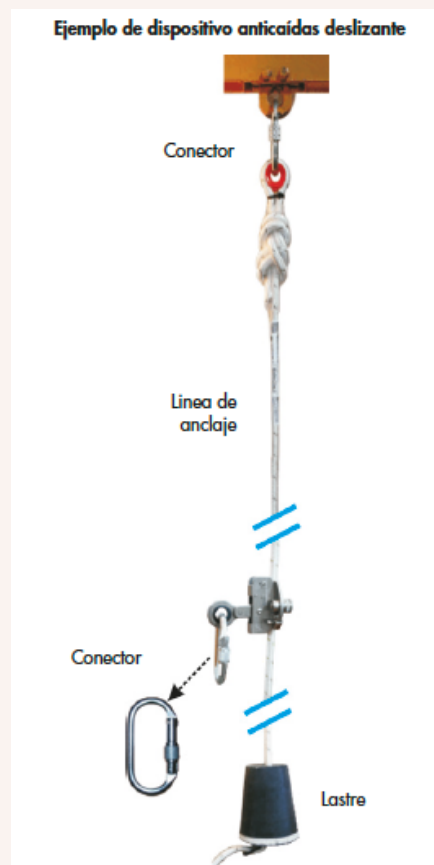
Ejemplo de dispositivo anticaída deslizante. Fuente: INSHT. Equipos de protección individual. Aspectos generales sobre su comercialización, selección y utilización
