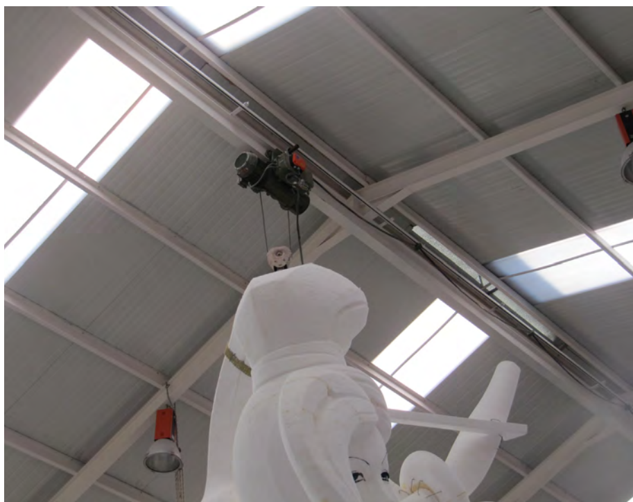
Ejemplo de grúa monocarril. INVASSAT
