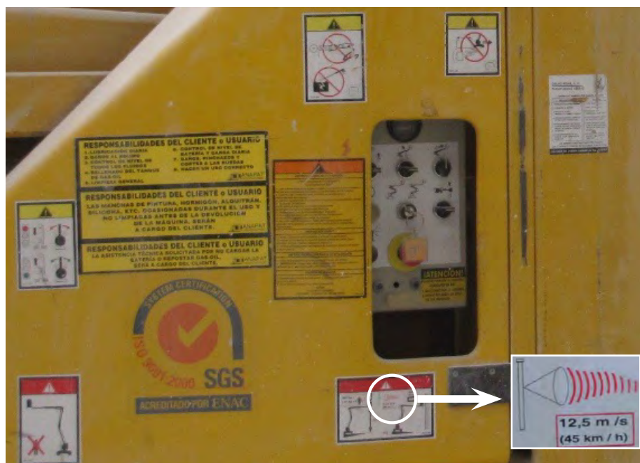
Señalizaciones en PEMP, incluida máx. velocidad de viento, cuyo detalle se resalta en la imagen. INVASSAT
