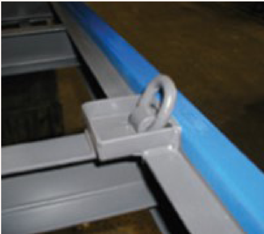
Ojal de fijación. Fuente: Comisión Europea. Guía europea de mejores prácticas sobre sujeción de cargas para el transporte por carretera
