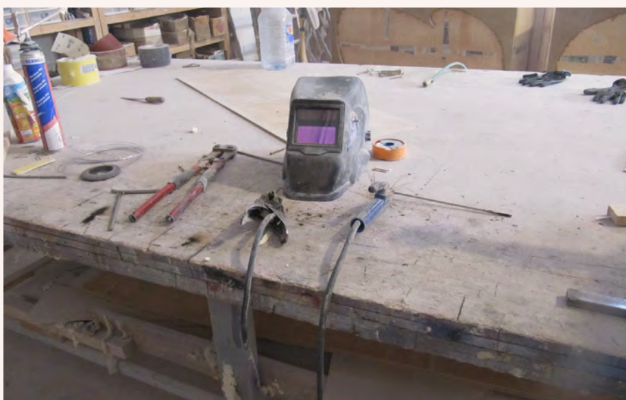
Pantalla protectora. Cable de soldeo con portaelectrodo y electrodo. Cable de masa con su pinza. INVASSAT
