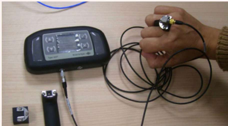
Vibrómetro (1-monitor, 2-acelerómetro, 3-cable, 4-adaptadores). Fuente: insst.es (Documentos INSST)
