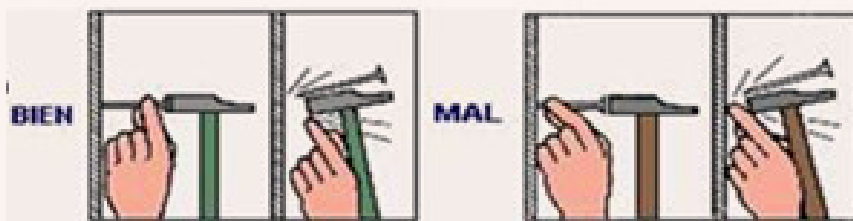
Sujeción correcta del clavo. Fuente: INSHT. NTP 393
