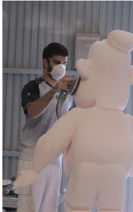
Utilización de mascarillas autofiltrantes tipo FFP en operaciones de lijado con lijas manuales y lijadoras eléctricas. INVASSAT
