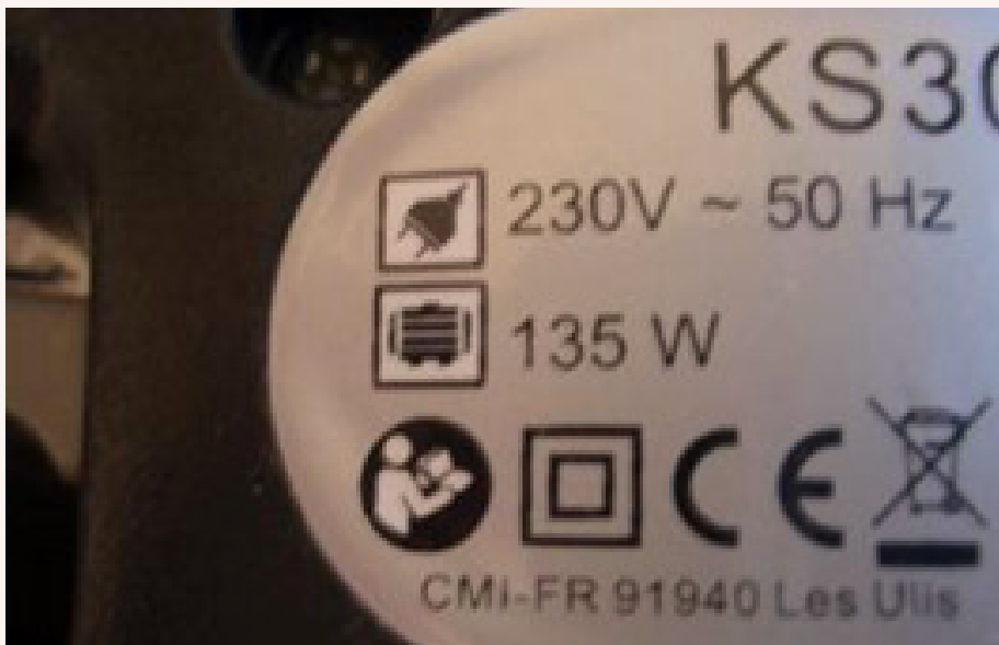
Herramienta manual con doble aislamiento. Fuente: ealuro.com
