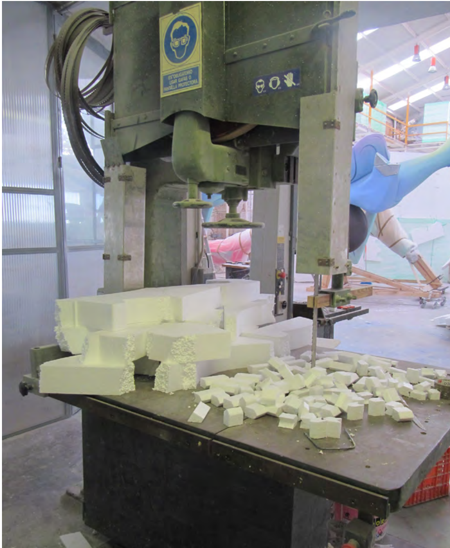
Sierra de cinta empleada en el corte de tableros de poliestireno expandido. INVASSAT
