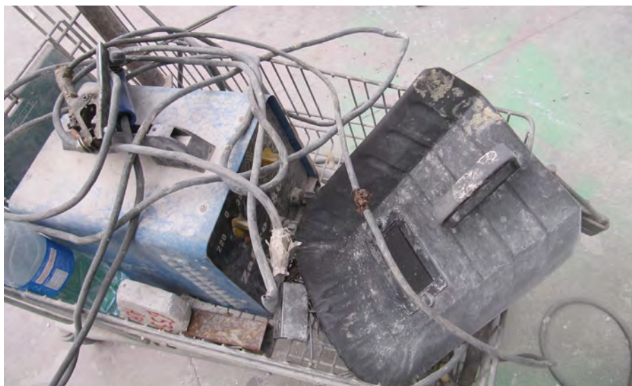
Equipo de soldadura eléctrica al arco en taller fallero y de hogueras. INVASSAT
