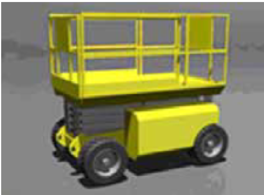
PEMP tipo tijera con barandillas en su plataforma. Fuente: INSHT. NTP 1039: Plataformas elevadoras móviles de personal (I): gestión preventiva para su uso seguro
