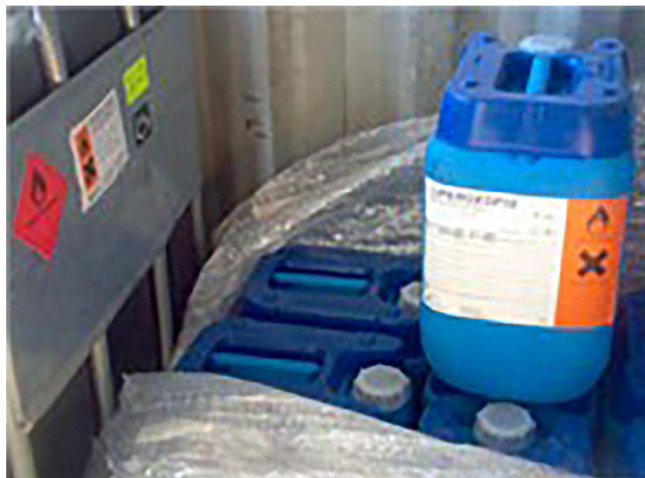
Almacenamiento conjunto incorrecto. Se almacenan conjuntamente sustancias inflamables y comburentes. INVASSAT
