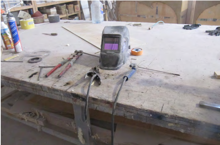
Detalle de pinzas, electrodo y careta de soldadura. INVASSAT
