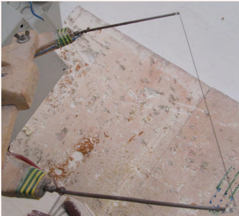
Hilo caliente para recorte de poliestireno expandido, alimentado a 24 voltios. INVASSAT
