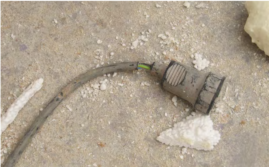
Manguera eléctrica que ha perdido su aislamiento original. INVASSAT
