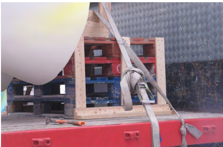
Detalle de apoyo de un extremo de la figura por medio de palets firmemente unidos entre sí y a la propia plataforma (bloqueo), con amarre superior a ésta con cincha. INVASSAT
