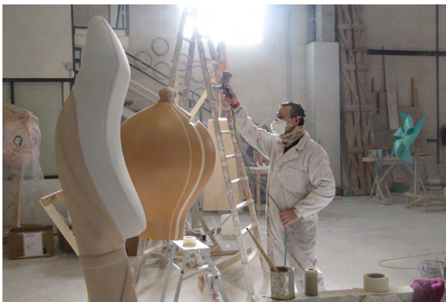
Operación de pintura con pistola aerográfica, realizada en el taller. INVASSAT
