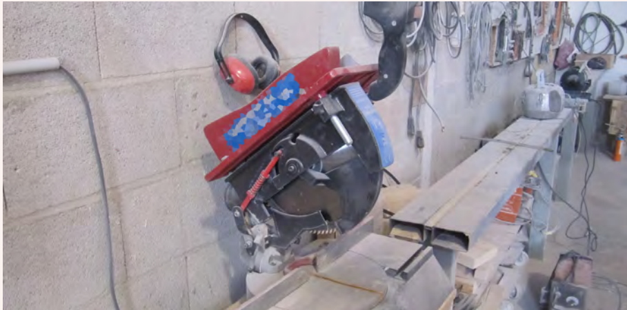
Ejemplo de protección de tronzadora-ingletadora utilizada en taller. INVASSAT
