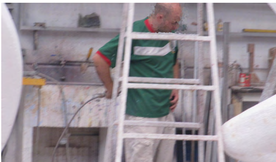
Uso de aire comprimido para llevar a cabo (de forma insegura) la limpieza del polvo que se ha ido depositado sobre el cuerpo y la ropa. INVASSAT
