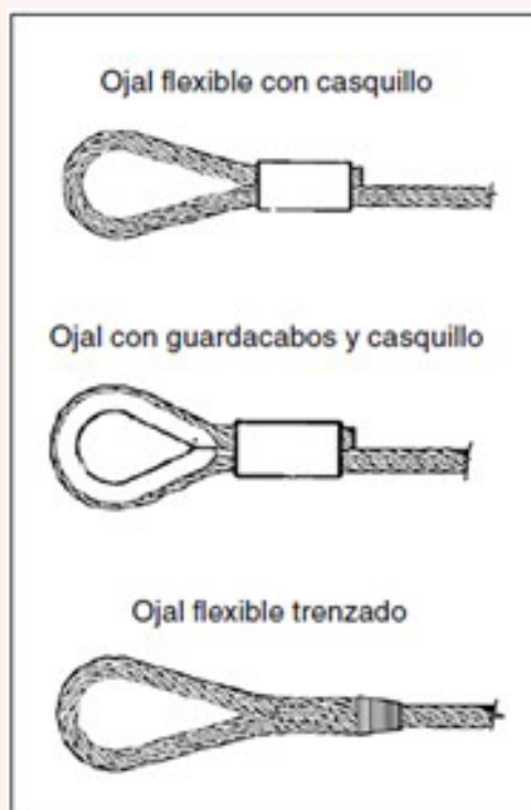
Diversos ojales trenzados y con casquillo. Fuente: INSHT. NTP 866
