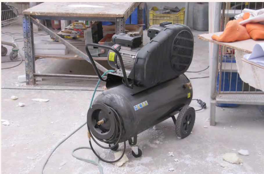
Compresor que incorpora un resguardo fijo de sus elementos de transmisión de movimiento. INVASSAT
