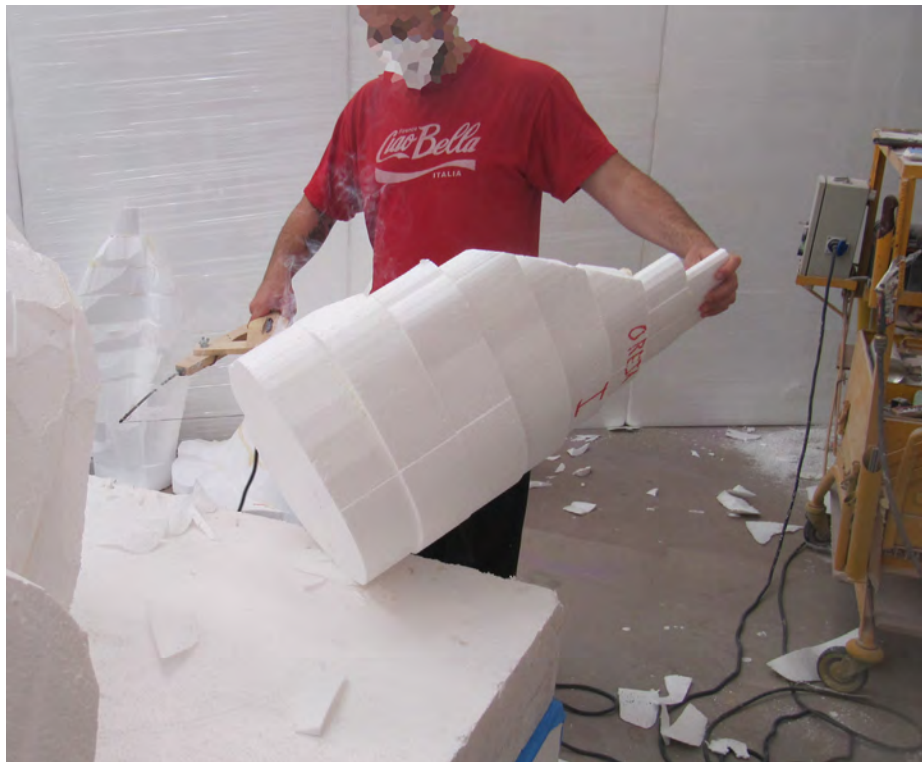
Operación de moldeado con hilo de hierro caliente. INVASSAT
