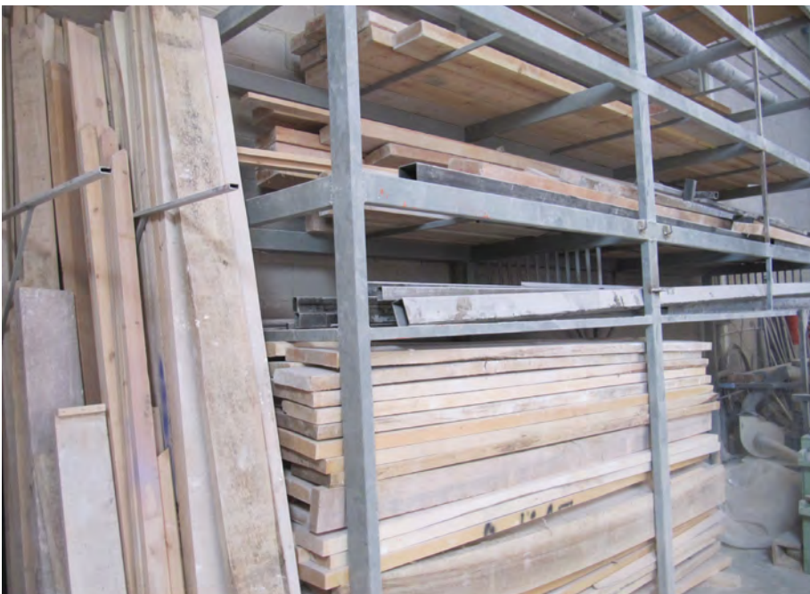
Ejemplo de almacenamiento de tablonos horizontal y vertical en un taller fallero. INVASSAT
