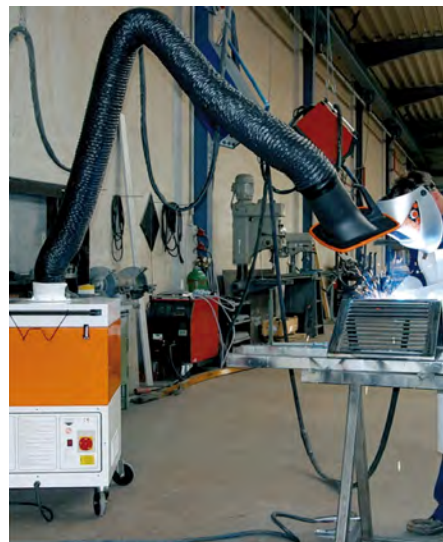
Equipo de ventilación por extracción localizada fijo, con varias tomas (izda.) y móvil (dcha.). Fuente: INSST (Basequim 007)
