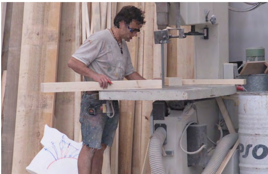
Corte mediante sierra de cinta, con alimentación manual. INVASSAT
