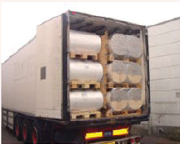
Relleno entre filas de carga. Fuente: Comisión Europea. Guía europea de mejores prácticas sobre sujeción de cargas para el transporte por carretera
