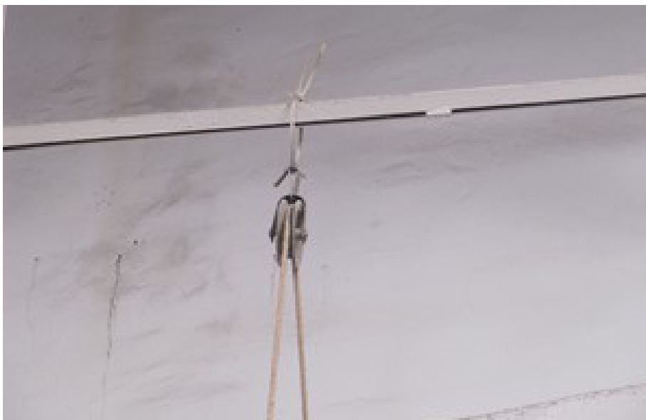
Ejemplo de polea simple utilizada en el taller fallero. INVASSAT
