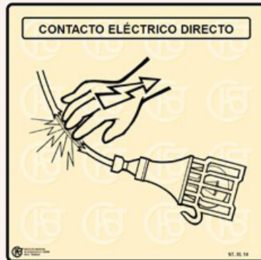
Contacto eléctrico directo. Fuente: INSHT. Condiciones de trabajo. Guía del monitor
