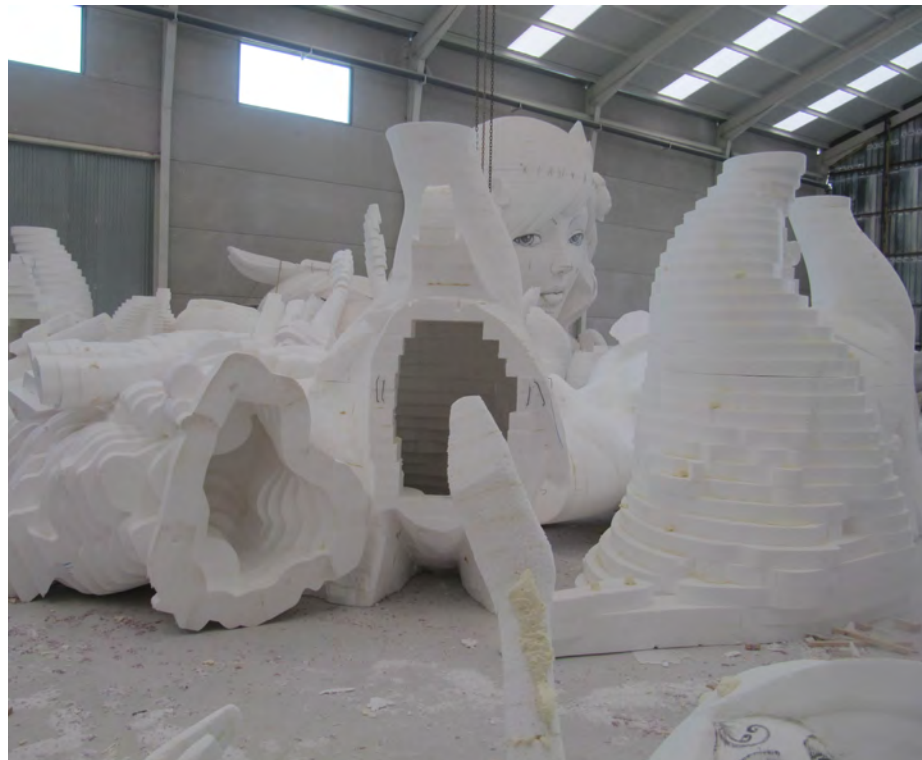
Figura conformada en bruto a base del pegado de las distintas capas que la conforman. INVASSAT
