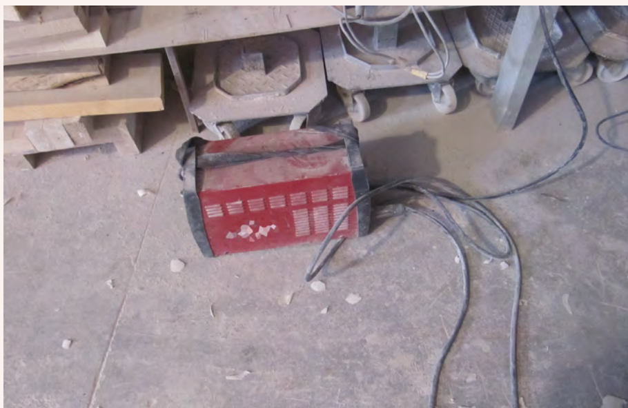
Equipo de soldadura al arco utilizado en taller fallero y "foguerer". IN-VASSAT
