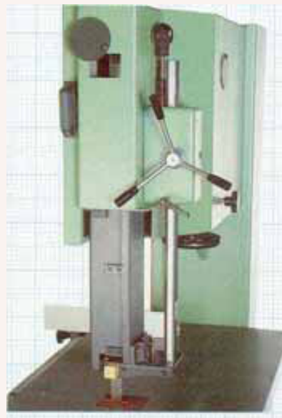
Protector A. Porlan y de regulación manual. Fuente: OSALAN
